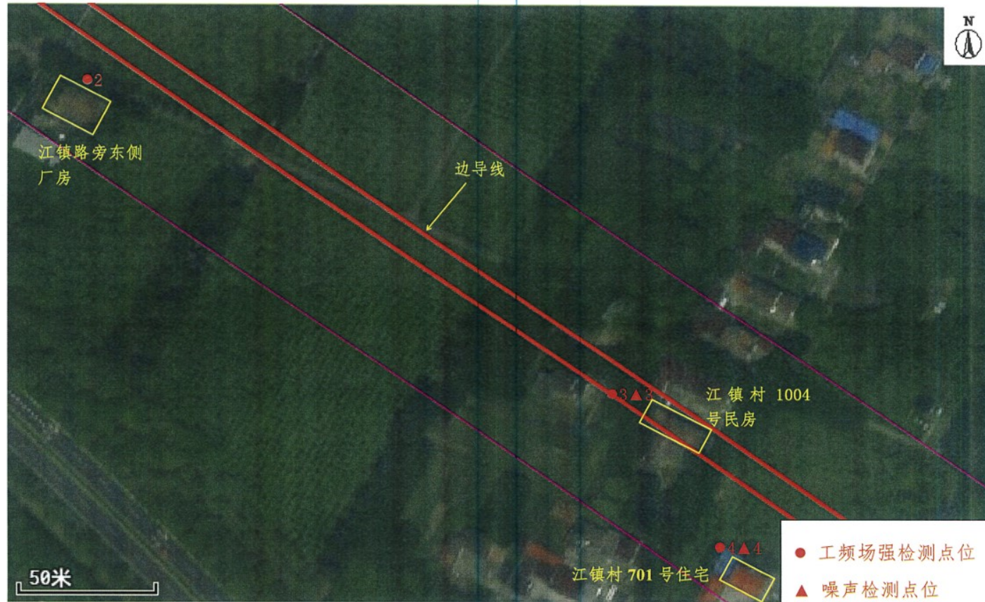
图 2 北沿江（沪渝蓉）铁路上海崇明牵引站 220 千伏外部供电工程电磁环境及噪声现状检测点位示意图
